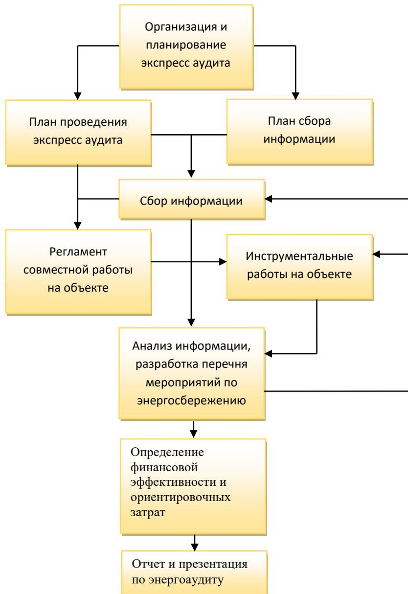
Рисунок 2 Блок-схема проведения экспресс-аудита трансформаторных подстанций
